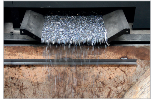
Chip automatic extraction Extracción automática de viruta
